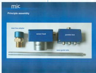
MIC—Sensor mit abnehmbaren Hohlleiter
