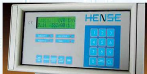
Auswerteelektronik mit Anzeige der Förderleistung
