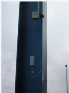
Wartungsfreier DMS- Sensor mit Schutzkappe
