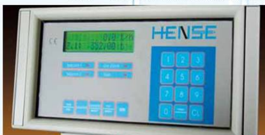
Auswerteelektronik mit Anzeige der Förderleistung
